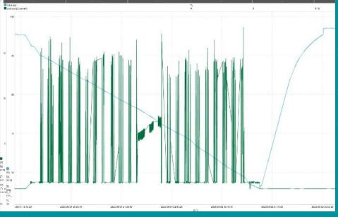
Die Darstellung zeigt den durchschnittlichen Verbrauch in einer Nachtschicht. Es ist gut erkennbar, dass der Butler S ausreichend Leistung und Kapazität für die angeschlossenen Verbraucher zur Verfügung stellt. Nach Abschluss der Nachtschicht lag der SoC immer noch bei rund 60%. Über den Tag hinweg wurde der Butler S für die nächste Nachtschicht wieder aufgeladen.
